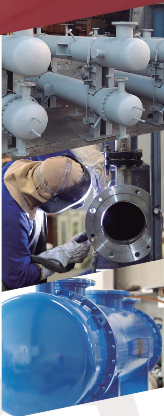
Trocadores de calor são equipamentos responsáveis pela refrigeração ou aquecimento de fluidos em estado líquido ou gasoso, cujo processo de troca térmica ocorre em contra corrente entre o casco e os tubos. São térmica e mecanicamente dimensionados de acordo com sua necessidade, possuem longa durabilidade e são de fácil limpeza e manutenção.
